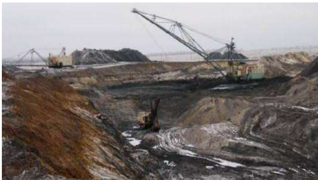
Шагающий экскаватор, занимающийся перевалкой горных пород на вскрышных работах
