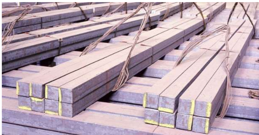
Сортовая заготовка квадратного сечения, полученная на Донецком электрометаллургическом заводе
