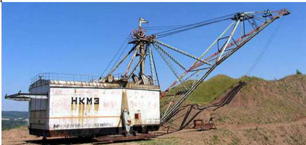
Механизм «шагания» включает в себя две лыжи и круглую раму снизу
