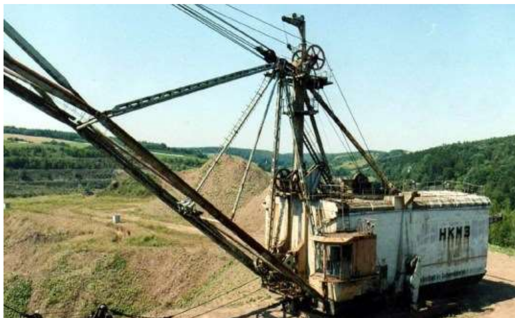
Назначение ЭШ – погрузка вскрытой породы на специально выработанное место или на борта разрезов
